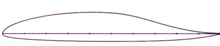
Le profil à **double courbure** (ou **autostable**) a une portance moyenne et traînée importante.
