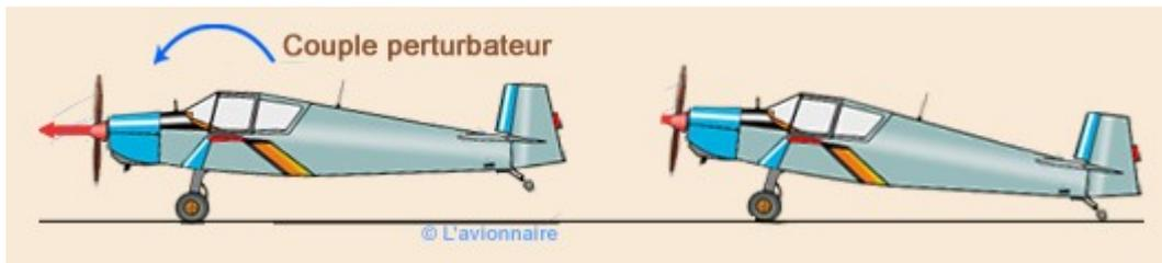
Un exemple de perturbation autour de l'axe de tangage : avion train classique au décollage . Quand on soulève la roulette arrière, rotation autour de l'axe de tangage → l'avion embarque à gauche. Compensé par « du pied à droite » !
