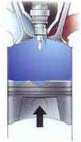
La bougie produit une étincelle : la combustion se produit. Les gaz chauds repoussent le piston, initiant le mouvement
