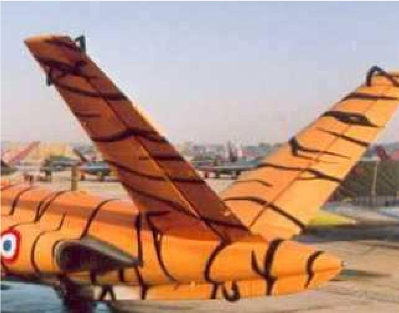
Les gouvernes ne sont pas toujours séparées sur les trois axes. Le contrôle en tangage et en roulis est assuré par les mêmes gouvernes sur la dérive papillon de ce Fouga magister.
