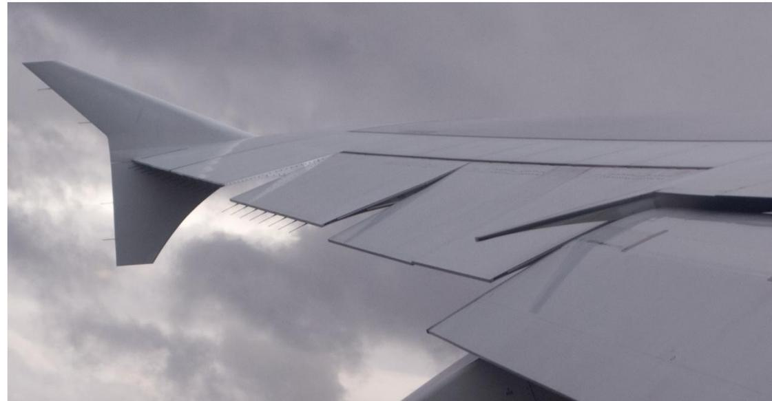
**A 380 : aileron en 3 sections. L'aileron externe n'est utilisé que jusque 300 kt**
