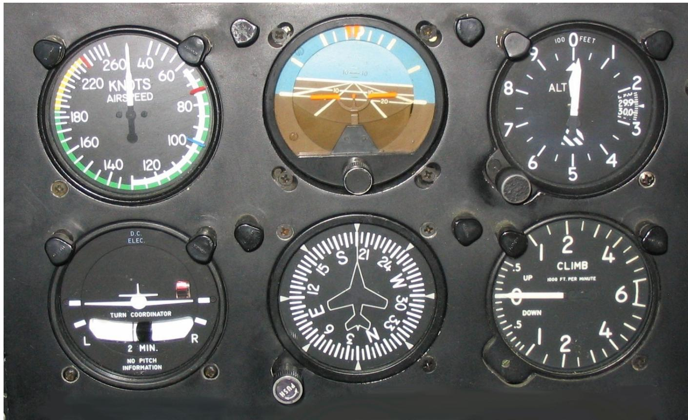
Pour faciliter la lecture des instruments (le "circuit des yeux") et augmenter la sécurité des vols les instruments sous forme "d'horloges" sont toujours disposés de la même manière quelque soit l'avion.
