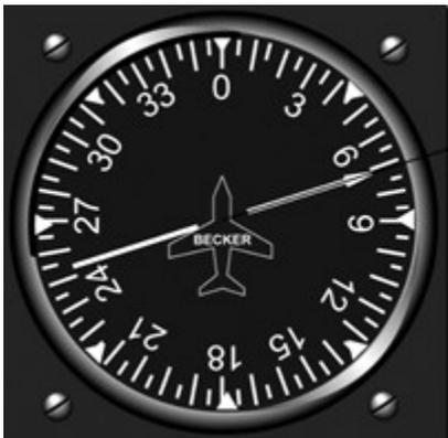
**Radiocompas** : pour atteindre une balise il suffit de placer la flèche de l'indicateur dans l'axe de l'avion.
