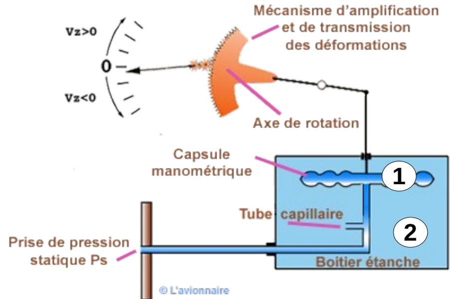
L'appareil mesure la **différence de pression entre le réservoir et la capsule**
