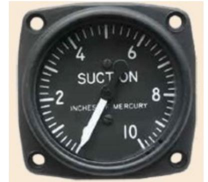
Sur un avion, la mise en rotation du gyroscope est pneumatique (pression ou au contraire **succion**, contrôlée par un indicateur) ou électrique.
