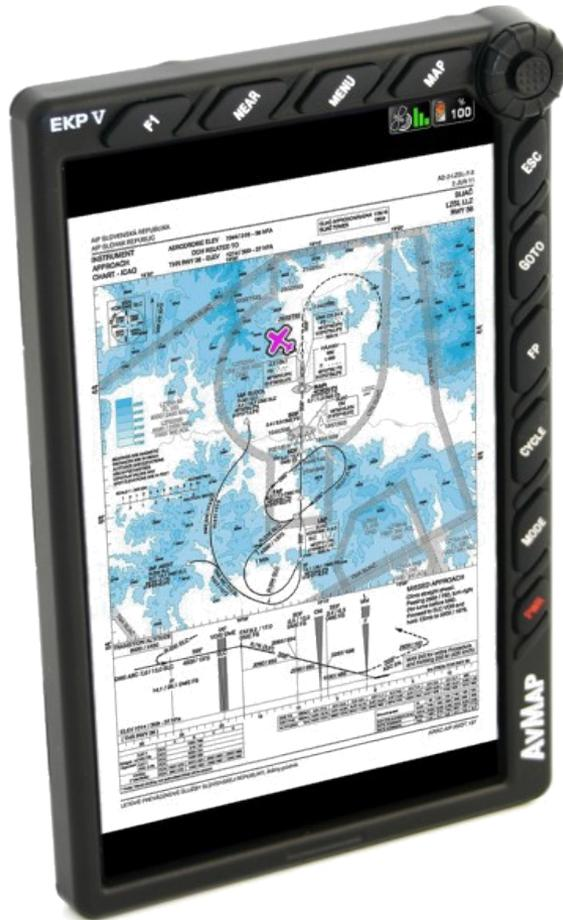
Le GPS <sup>(1)</sup> est un système de positionnement américain basé sur de la triangulation à partir de 24 satellites en orbite basse envoyant des signaux vers la terre.
