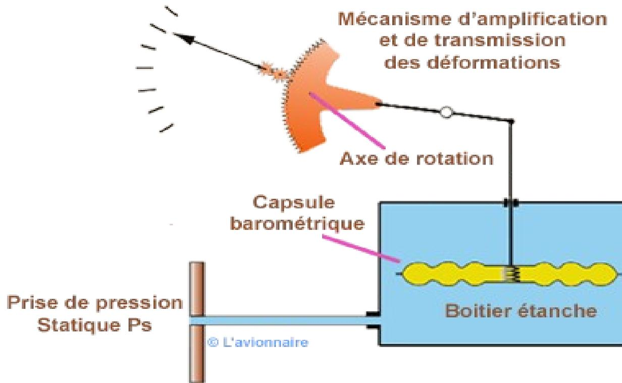
L'altimètre est un baromètre (mesure de pression statique) gradué en pieds. Il est étalonné sur l'atmosphère standard:
