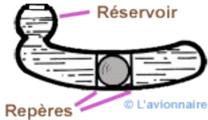
La bille est constituée d'un tube légèrement courbé contenant une goutte de mercure immergée dans un liquide visqueux.
