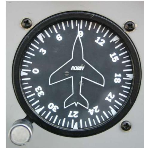
Le conservateur de cap (ou gyrocompas) est basé sur un gyroscope à 2 degrés de liberté à axe vertical. Il est calé sur la direction du N magnétique, et la garde.
