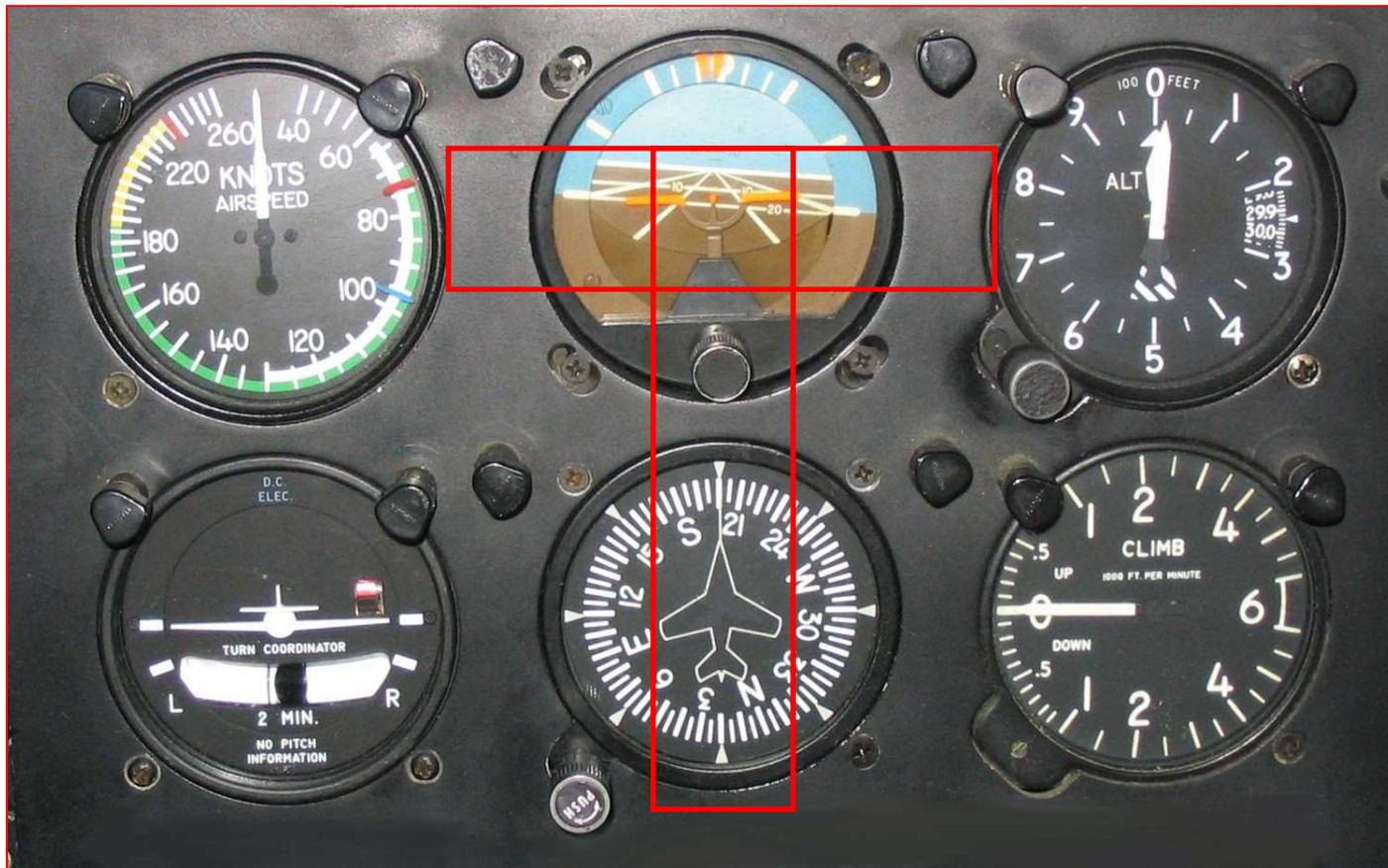
**Pour faciliter la lecture des instruments (le "circuit des yeux") et augmenter la sécurité des vols les instruments sous forme "d'horloges" sont toujours disposés de la même manière quelque soit l'avion.**
