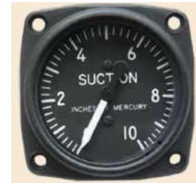
Sur un avion, la mise en rotation du gyroscope est pneumatique (pression ou au contraire **suction, contrôlée par un indicateur**) ou électrique.
