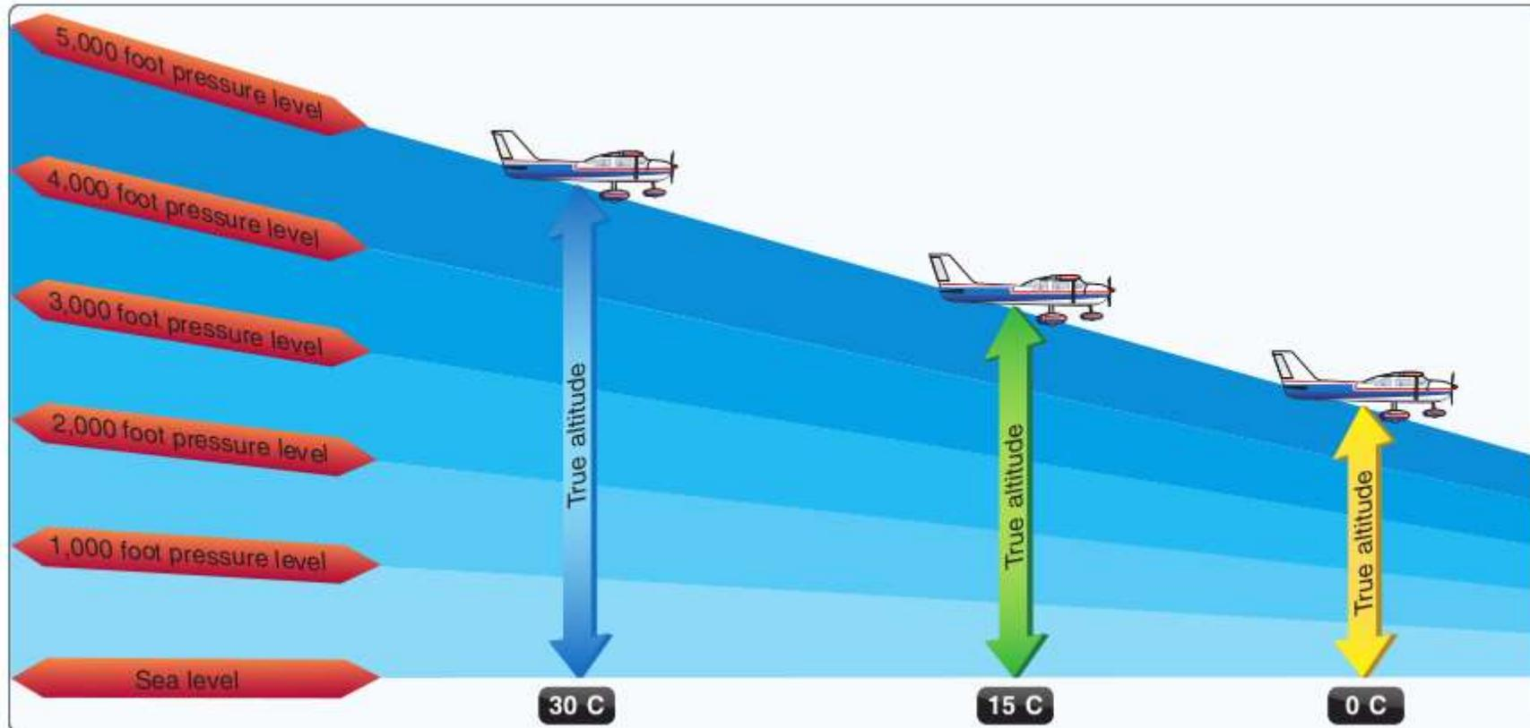
**Effets d'une température non standard sur l'indication de l'altimètre :**
