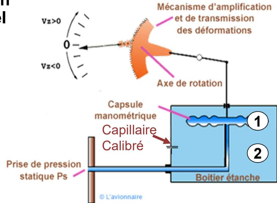
(2) réservoir mis en pression par l'intermédiaire d'un capillaire calibré : mise en pression lente, pression "en retard" d'un temps  $t$  sur la pression vraie
