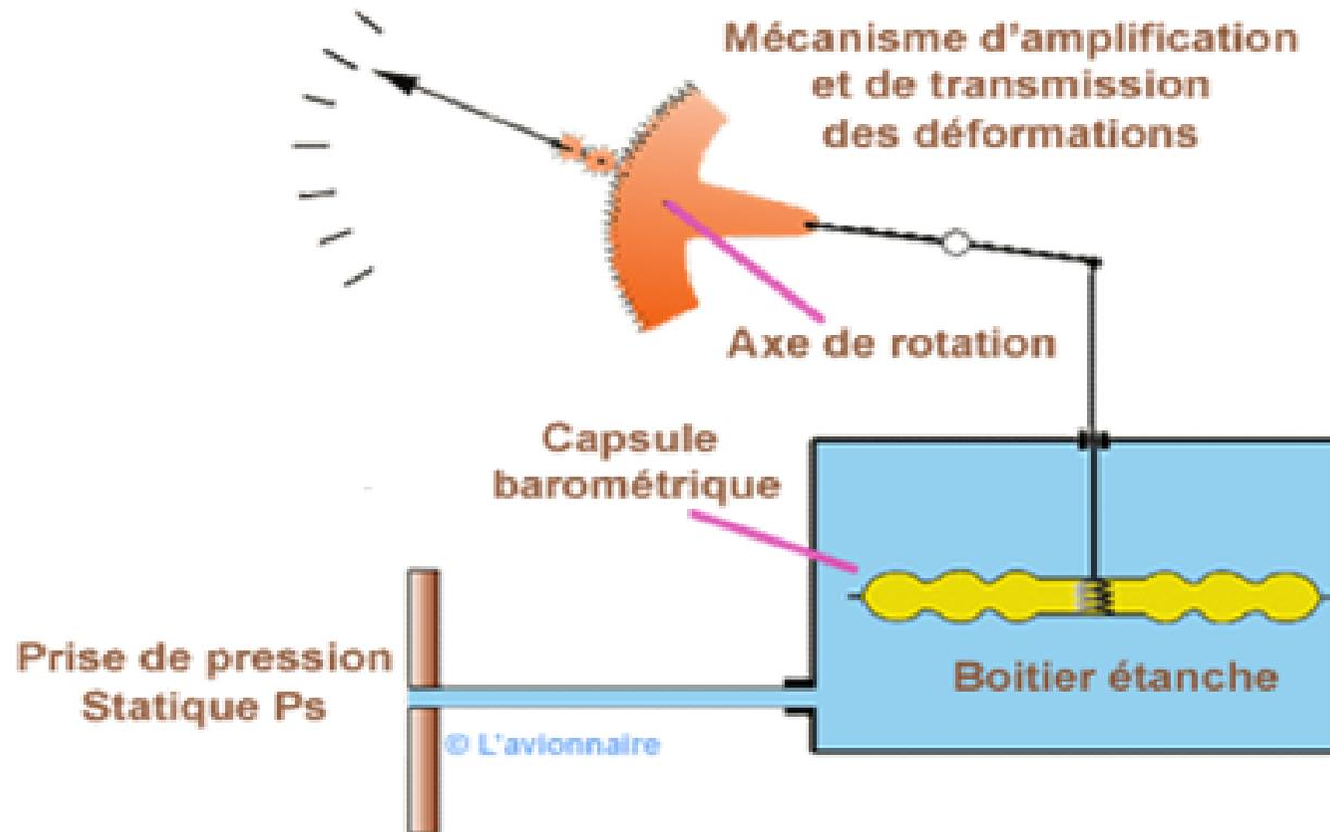
L'altimètre est un baromètre (mesure de pression statique) gradué en pieds. Il est étalonné sur l'atmosphère standard:
