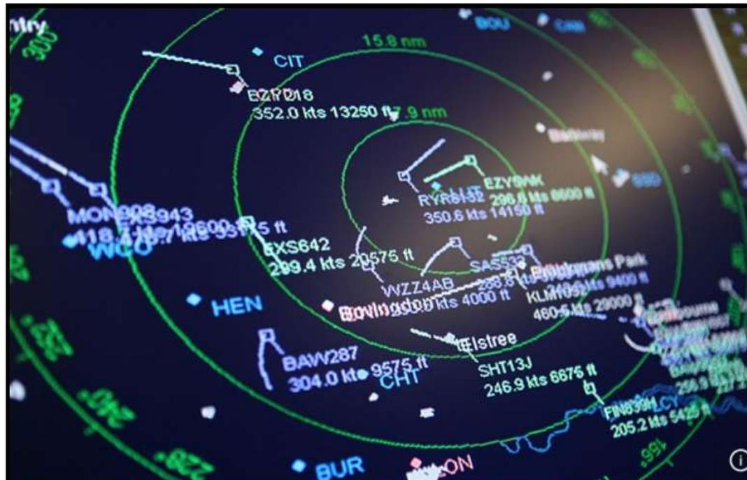
Les transpondeurs les plus récents transmettent au contrôle, outre l'altitude, de nombreux paramètres du vol
