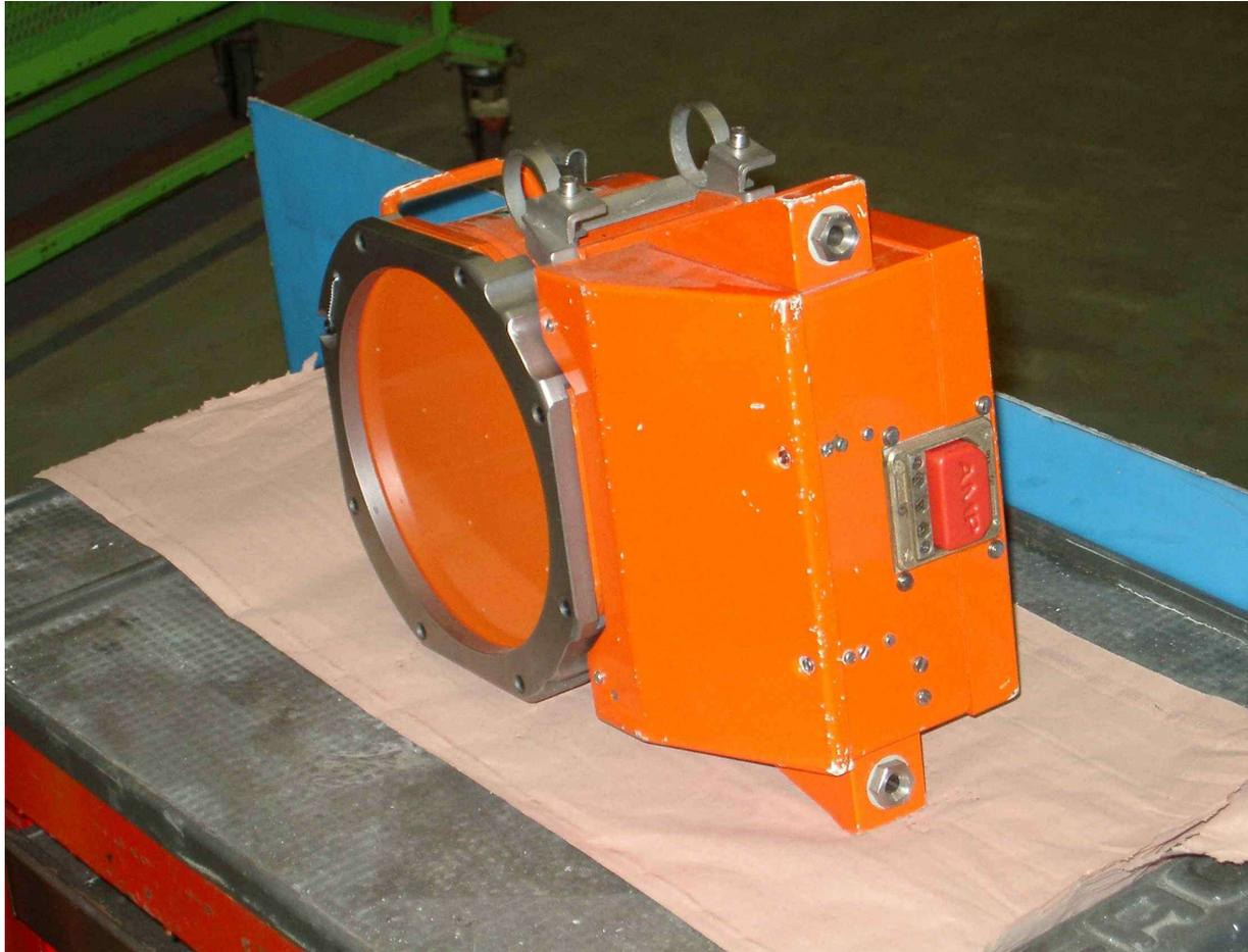
Uniquement sur les avions commerciaux ou militaires. En réalité, 2 boîtes noires, de couleur vive : (1) enregistrement de ce qui se dit dans le cockpit, et (2) enregistrement de nombreux paramètres de vol. Complète la **balise de détresse**
