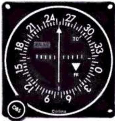
**VOR: Peut être utilisé pour la navigation et l'atterrissage de précision. Bonne fiabilité.**
