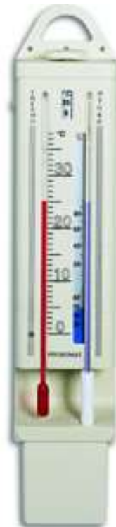
un psychromètre (combinaison d'un thermomètre mouillé et d'un thermomètre sec)
