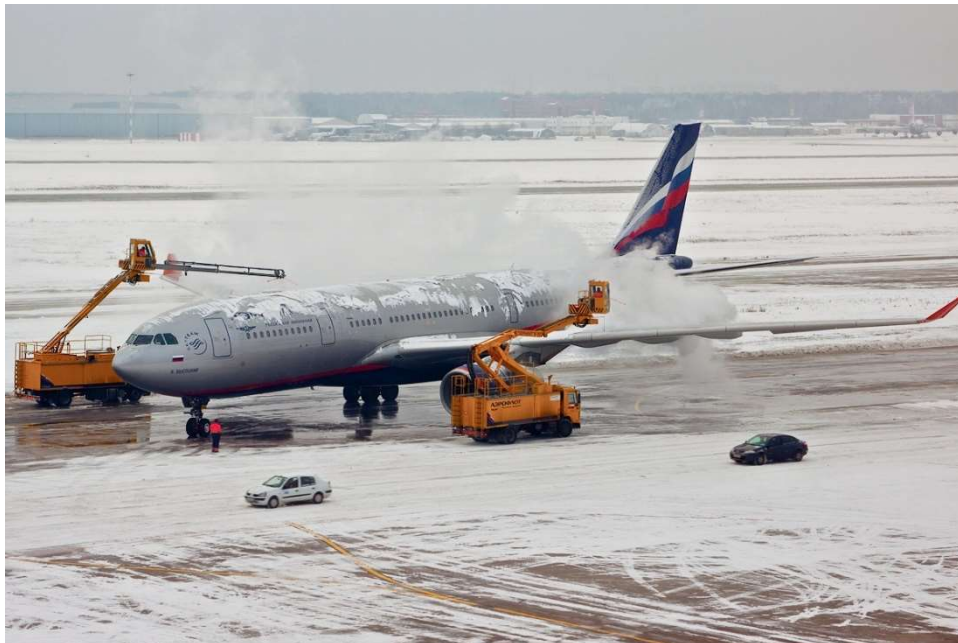
Dégivrage au sol d'un avion avant son décollage (pulvérisation de glycol)
